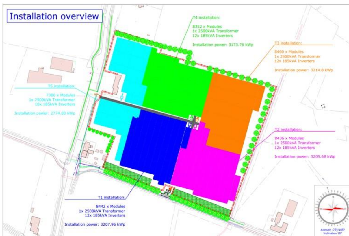
Figuur 7 Bouwtekening zonnepanelen
